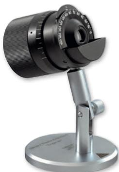
L'œil artificiel pour la skiascopie est idéal pour l'entraînement et l'enseignement. Réglage précis du diamètre de la pupille et de la réfraction. L'encoche antérieure permet l'interposition de deux verres d'essai. La détermination des cylindres est réalisée à l'aide des valeurs angulaires.
